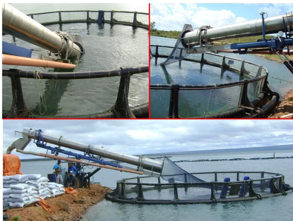
**Figura 1.** Tanque rede de 240 m<sup>3</sup> conjugado com equipamento para despesca mecanizada.
